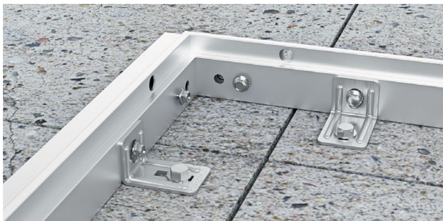
Fissaggio del profilo del telaio del pavimento in alluminio Berry su supporto irregolare con fondazione a vite
